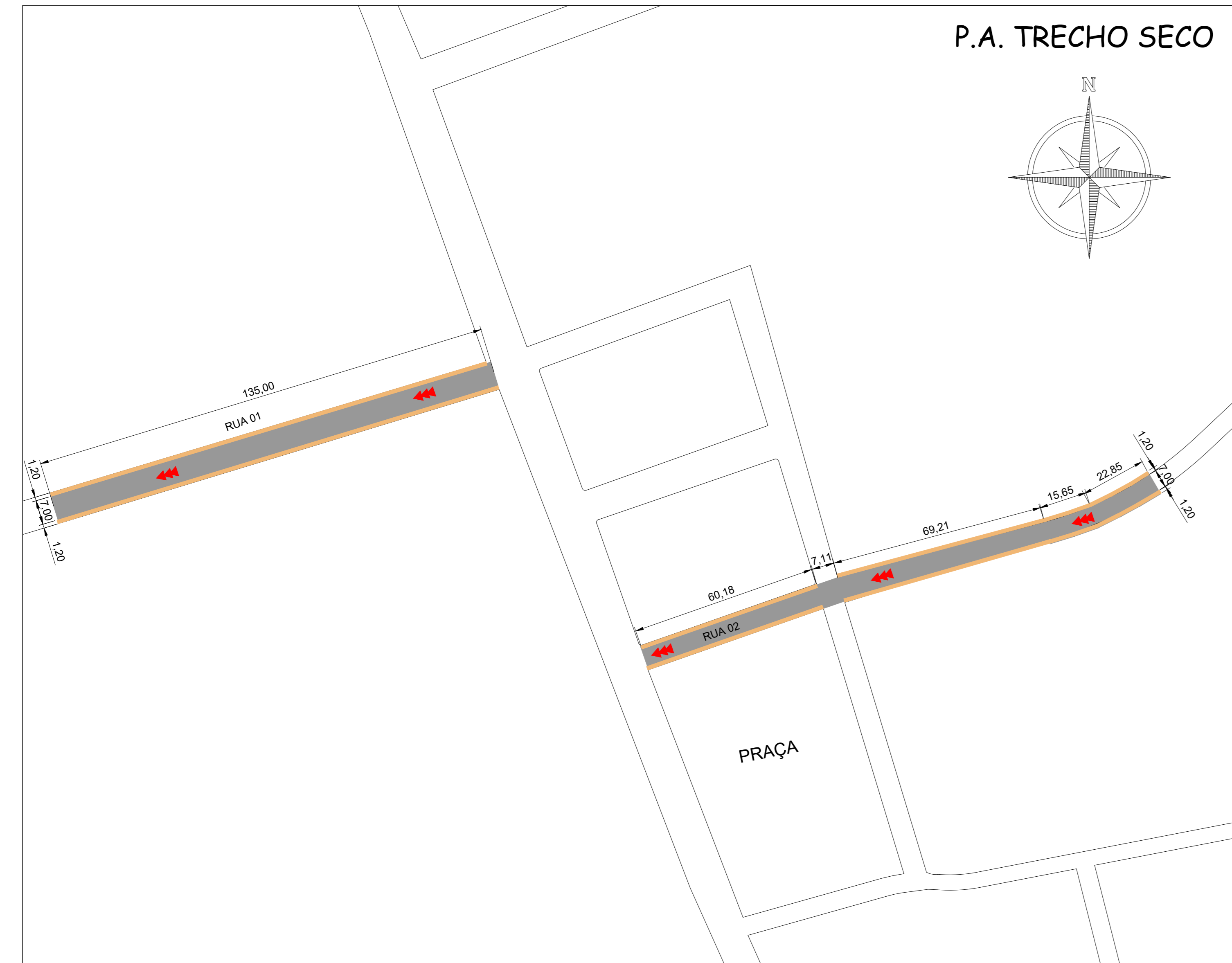
PLANTA DE PAVIMENTAÇÃO Esc: 1/1000
